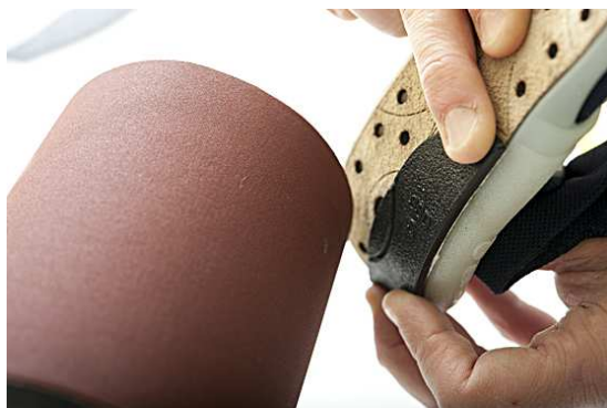
5. Fase di rifinizione dei moduli applicati
