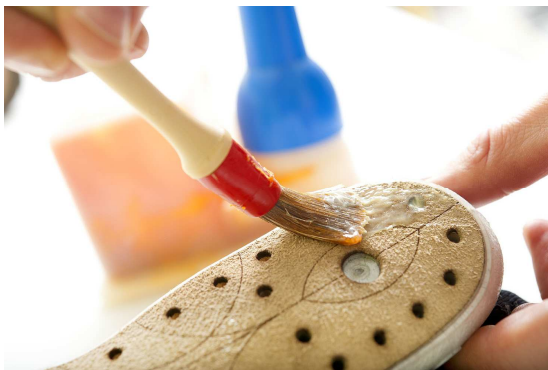
3. Posizionamento del collante sulla scarpetta
