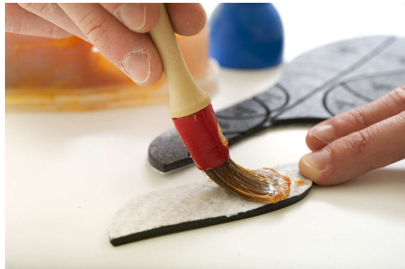
2.Posizionamento del collante sul modulo
